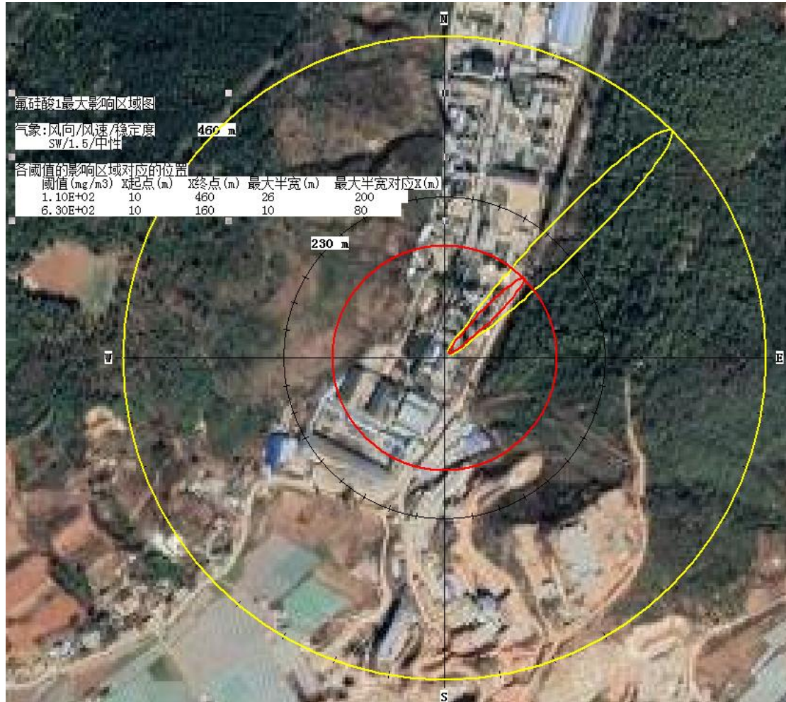
图 7.5-4 最常见气象条件氟硅酸储罐泄漏最大影响区域图
